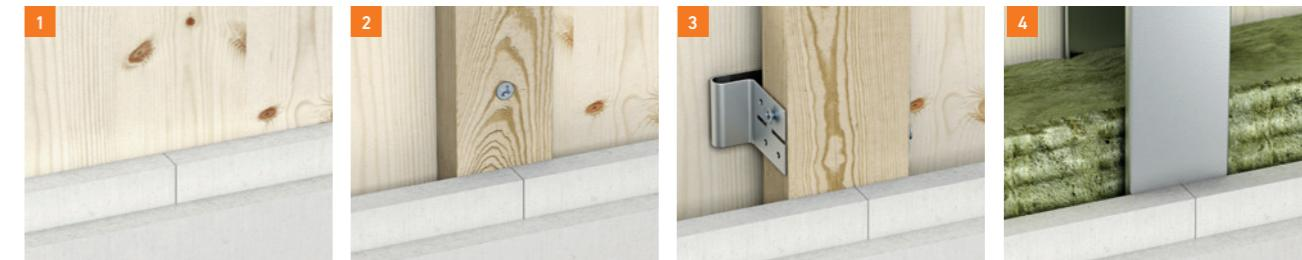
Plaatkate otse massiivpuidule/ristikihile/puidule (alternatiiv puidupöhised plaadid)
